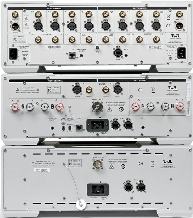
го ИК-датчика (кстати сказать, встроенного датчика здесь нет вообще), релейного сигнала 12 В и фирменной управляющей шины H Link. Наконец нельзя не отметить два (!) гнезда сетевого кабеля. Дело в том, что P 3000 HV оснащен двумя блоками питания. Один обслуживает цифровые узлы, другой — аналоговые. Блоки питания импульсные, удалены друг от друга на максимальное расстояние. Столь радикальное решение проблемы взаимных помех и наводок нечасто отличает даже High-End-аппаратуру.
